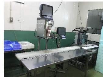
自動計量ラベル貼付システム
